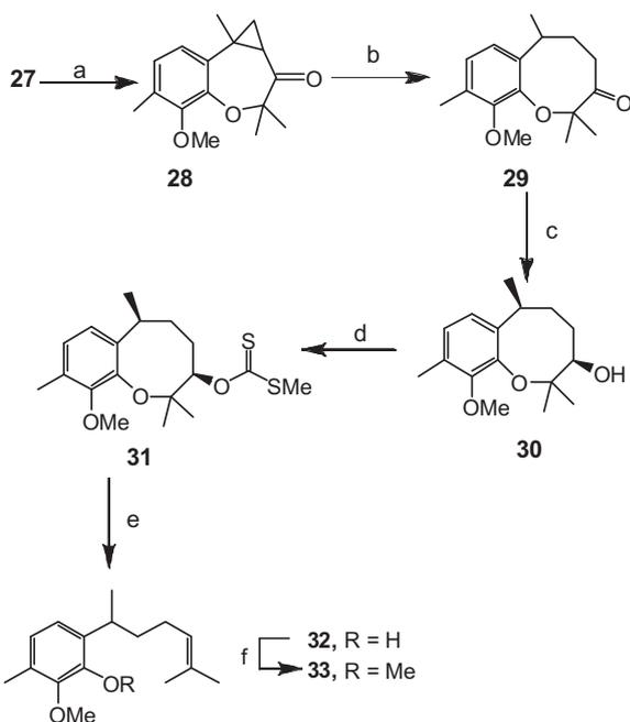
**Scheme 4.** Reagents and conditions: (a)  $Pd(OAc)_2$ ,  $CH_2N_2$ , ether,  $0^\circ C$ , 3 h, 72%; (b)  $H_2$ , Pd/C, EtOH, 2 h, 90%; (c)  $NaBH_4$ , MeOH,  $0^\circ C$ , 95%; (d) NaH,  $CS_2$ , MeI,  $0^\circ C$  to rt, 8 h, 92%; (e) TBTH, AIBN, toluene, reflux, 3 h, 90%; (f) MeI,  $K_2CO_3$ , acetone, reflux, 4 h, 97%.
