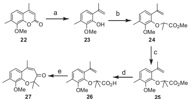
**Scheme 3.** Reagents and conditions: (a) KOH, ethylene glycol, reflux, 2 h, 50%; (b)  $K_2CO_3$ ,  $CH_3CH(Br)COOMe$ , acetone, reflux, 5 h, 87%; (c) LDA, THF, MeI,  $-20^\circ C$  to rt, 2 h, 90%; (d) 10% NaOH, MeOH,  $50^\circ C$ , 1 h, 94%; (e)  $SOCl_2$ , benzene, reflux, 3 h, 68%.
