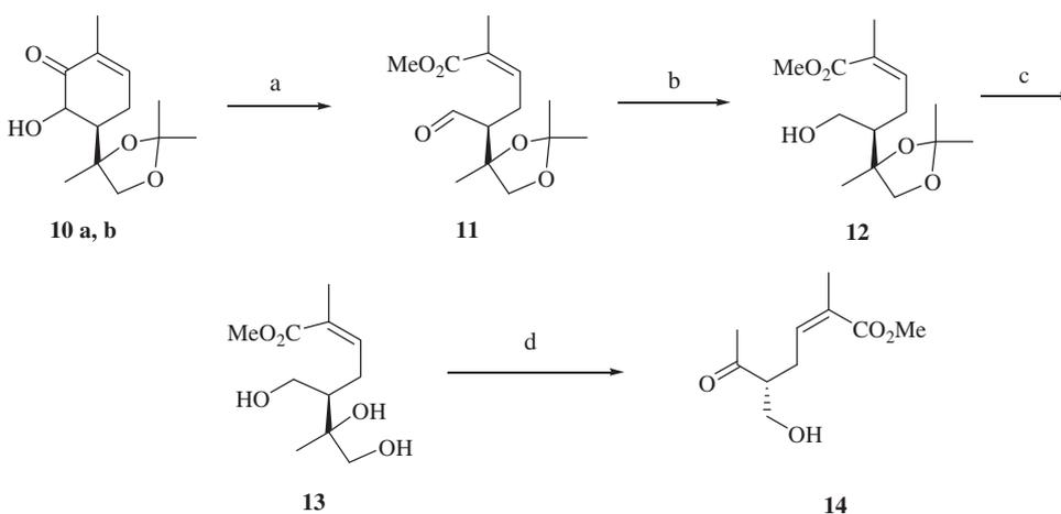
a)  $\text{Pb}(\text{OAc})_4$ ,  $\text{MeOH}-\text{C}_6\text{H}_6$  (1:1), 0 °C to rt, 20 min, 92%; b)  $\text{NaBH}_4$ ,  $\text{CeCl}_3 \cdot 7\text{H}_2\text{O}$ ,  $\text{MeOH}$ , 5 °C to rt, 1 h, 96%; c) 1% aq.  $\text{HCl}$ ,  $\text{THF}$ , 50 °C, 5 h, 85%; d)  $\text{Pb}(\text{OAc})_4$ ,  $\text{MeOH}-\text{C}_6\text{H}_6$  (1:1), 0 °C to rt, 20 min, 96%.
