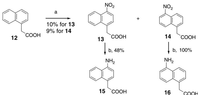
**Scheme 3.** Reagents: (a)  $\text{HNO}_3$ ,  $\text{CH}_3\text{COOH}$ ; (b)  $\text{H}_2$ ,  $\text{Pd}/\text{C}$ ,  $\text{EtOH}$ .
