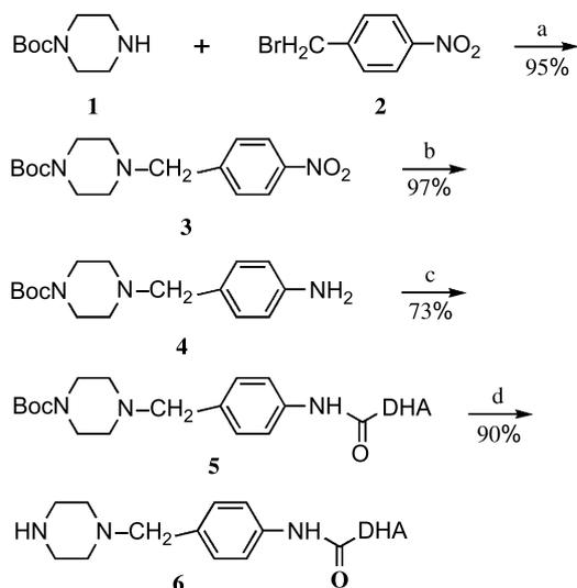
**Scheme 1.** Synthesis of compound **6**. Reagents: (a)  $K_2CO_3$ , DMF; (b)  $H_2$ , Pd/C; (c) DHA, HBTU; (d) HCl/EtOAc.
