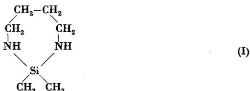
die unter Aufspaltung des Ringes zu spontaner Polymerisation neigt. Der Polymerisationsgrad beträgt nach 24 Stdn. 5,3, nach 10 Tagen 6,0.
