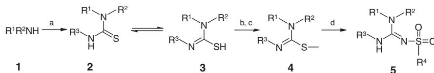
**Scheme 1.** Reagents and conditions: (a)  $R^3N=C=S$ ,  $CH_3CN$ ,  $N_2$ , rt, 2 h, except for **5h** (20 h); (b)  $CH_3I$ , rt, 18 h; (c) concentration in vacuo; (d)  $R^4SO_2NH_2$ ,  $KHCO_3$ ,  $MeCN$ , reflux, 22 h, except for **5d** and **5i** (72 h).
