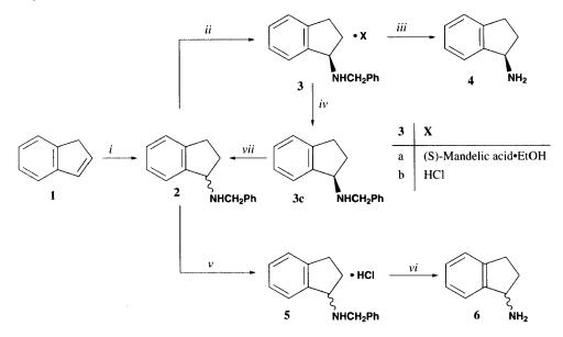
*i*) a) HCl<sub>g</sub> b) PhCH<sub>2</sub>NH<sub>2</sub>/toluene *ii*) (S)-Mandelic acid/ethanol *iii*) Pd/C, 3 At H<sub>2</sub>/ethanol *iv*) NaOH/H<sub>2</sub>O *v*) 32% HCl/isoropanol *vi*) Pd/C, 3 At H<sub>2</sub>/ethanol *vii*) Pd/C, NaOH, 0.5 At H<sub>2</sub>/ethanol
