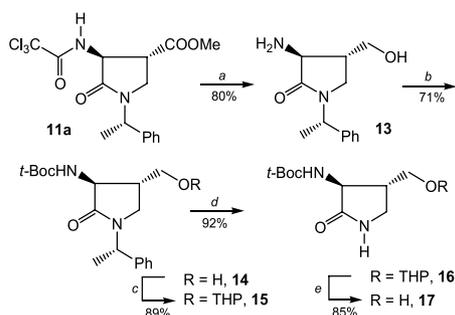
Scheme 5. Reagents and conditions: (a)  $\text{NaBH}_4$  (4 equiv), dry EtOH, rt; (b)  $t\text{-Boc}_2\text{O}$ , MeOH, rt; (c) DHP, DCM, H 15, rt; (d) Li,  $\text{NH}_3$ ,  $-78^\circ\text{C}$ ; (e) Amberlyst H 15, MeOH,  $40^\circ\text{C}$ .
