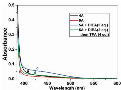
**Figure 3.** Absorption spectra of (a) [2]catenane 4A ( $1 \times 10^{-4}$  M), (b) [2]catenane 5A ( $1 \times 10^{-4}$  M), (c) 5A ( $1 \times 10^{-4}$  M) + DIEA (2 equiv), and (d) 5A ( $1 \times 10^{-4}$  M) + DIEA (2 equiv) then TFA (4 equiv) in  $\text{CH}_3\text{CN}$ .
