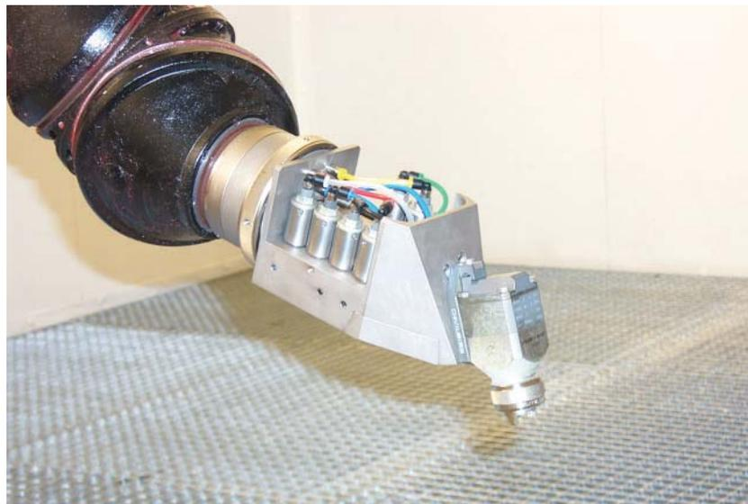
Hier die neue Pistolen-Halterung mit Farbventilen und integriertem Statikmischer auf dem Roboter
