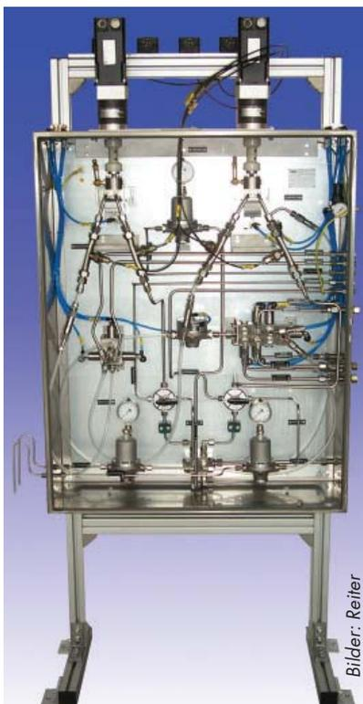
Der Dosierschrank mit Auslitereinheiten für 3 Farben, 1 Härter und 1 Spülmittel
