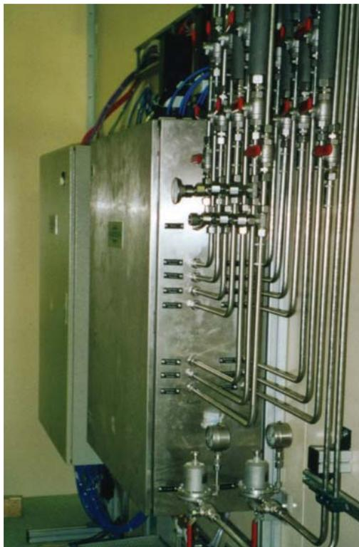
*Der Dosierschrank und der Modulschrank für eine 2K-Anlage, in der mit 7 Farben, 2 Härtern und 2 verschiedenen Spülmitteln gearbeitet wird*
