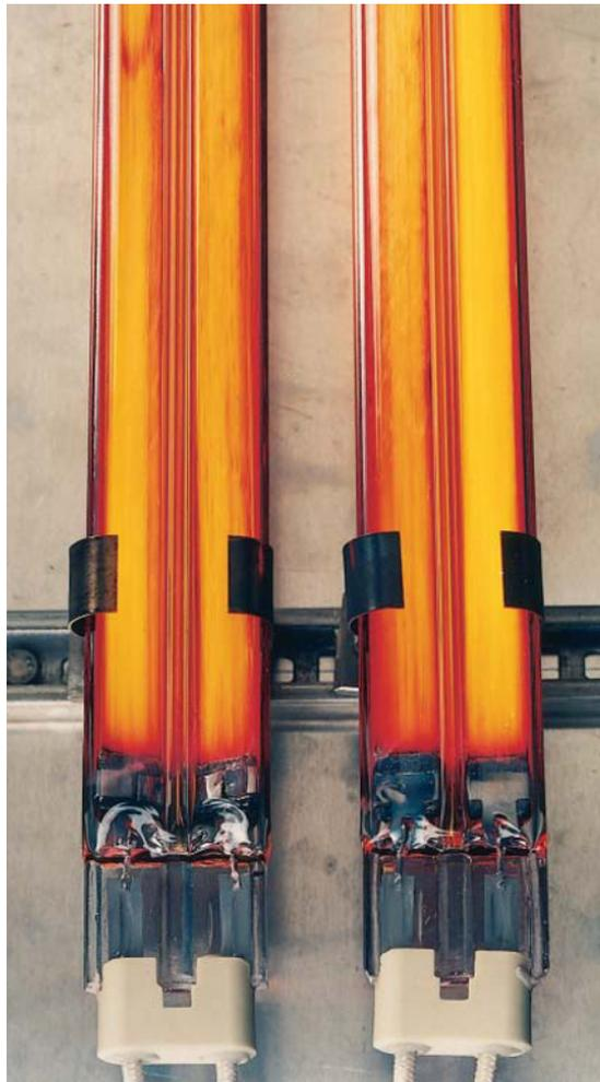
*Carbon-Zwillingsrohr-Strahler kombinieren die Carbon-Technologie mit den bewährten Quarzglas-Zwillingsrohren. Dadurch wird die Strahldichte wesentlich erhöht und gleichzeitig werden Strahlerlängen bis zu 3 m möglich.*
