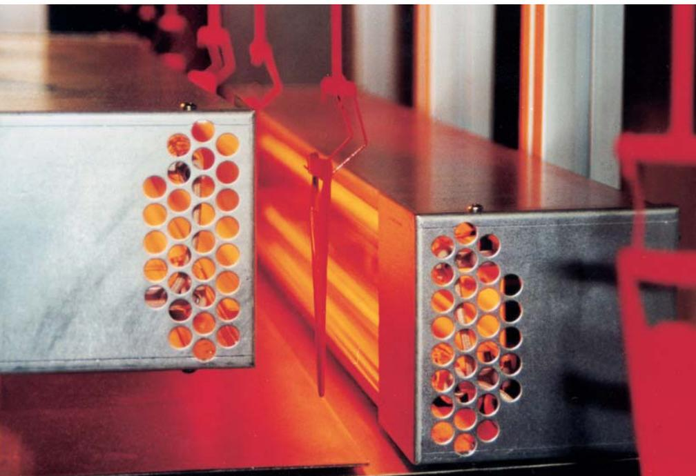
Lackpulver wird auf Flaschenöffner aus Metall aufgebracht, mit Carbon-Infrarot-Strahlern auf 180 °C aufgeheizt, geschmolzen und schließlich gehärtet.
