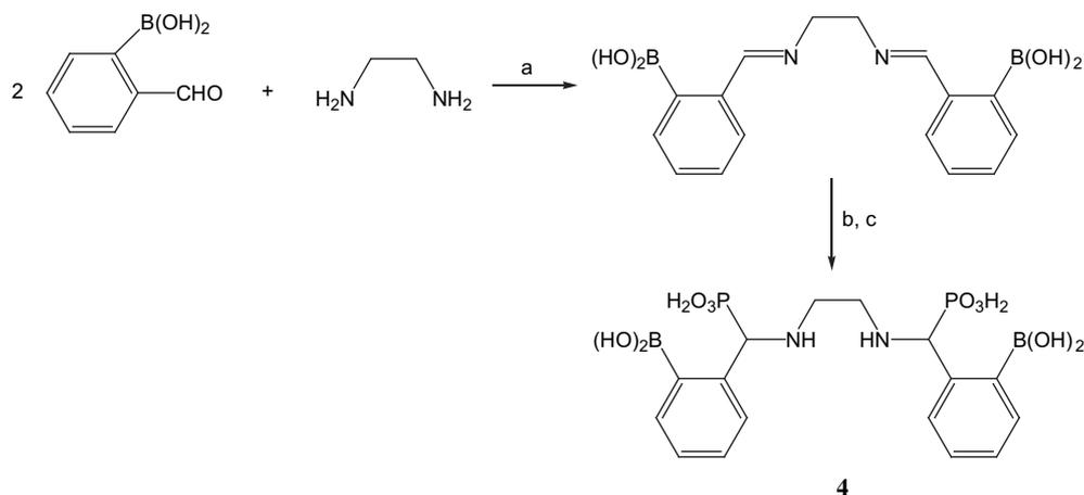
**Fig. 2.** Synthesis of *N,N*-ethyl aminoboronbenzylphosphonate **4**. a) MeOH, b) DCM,  $P(OSiCH_3)_3$ , c) 10% MeOH in  $H_2O$ .
