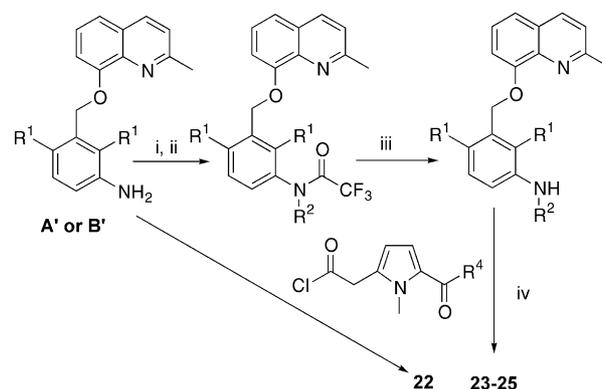
**Scheme 3.** (i)  $\text{TFAA}$ ,  $\text{CHCl}_3$ ; (ii)  $\text{NaH}$ ,  $R^2\text{X}$ ,  $\text{DMF}$ ; (iii)  $\text{NaBH}_4$ ,  $\text{MeOH}$ ; (iv) cat  $\text{DMAP}$ ,  $\text{DCM}$ .
