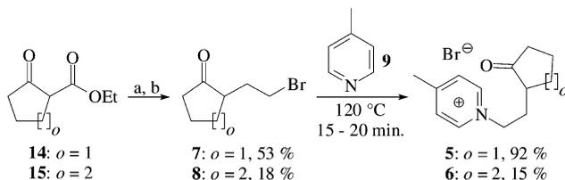
$o = 1$ : **a**)  $K_2CO_3$ ,  $Br(CH_2)_2Br$ , acetone, reflux 9 h, 65 %; **b**) 48 % HBr, reflux 30 min., 81 %.  $o = 2$ : **a**) NaH,  $Br(CH_2)_2Br$ , DMF, reflux 30 min., not isolated; **b**) 48 % HBr, reflux 30 min..
