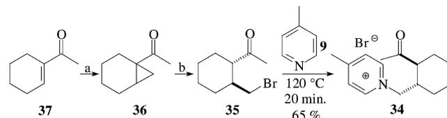
a)  $(\text{CH}_3)_3\text{SiO}^+\text{Tf}^-$ , NaH, DMSO, 42 %; b) TMSCl, NaBr,  $\text{CH}_3\text{CN}$ , 3 d, KF, 39 %.
