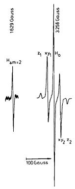
Abb. 1. EPR-Glasspektrum des Biradikals 5c in Toluol bei 160 K.
