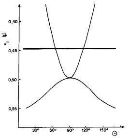
Abb. 3. Abhängigkeit der Energieeigenwertkoeffizienten  $x_1 = (\epsilon - \alpha)/\beta$  der vier obersten bindenden Orbitale des Biradikals 2c vom Diederwinkel (die übrigen Winkel haben die konstanten Werte  $\alpha = 50^{\circ}$ ,  $\beta_1 = 49^{\circ}$ ,  $\beta_2 = 51^{\circ}$ ).
