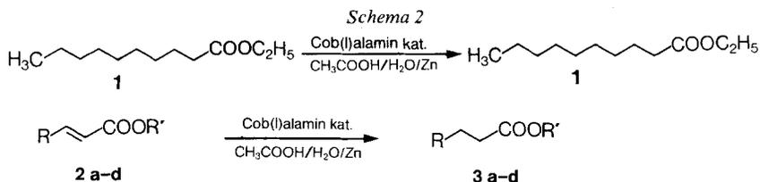
Tabelle 1. Reduktion von  $\alpha, \beta$ -ungesättigten Estern **2a-d** mit katalytischen Mengen Cob(I)alamin
