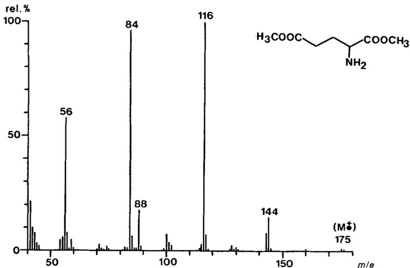
Fig. 1. Massenspektrum von Glutaminsäuredimethylester (1) als Hydrochlorid (70 eV, Direkteinlass 120°, 8 KV)<sup>6)</sup>
