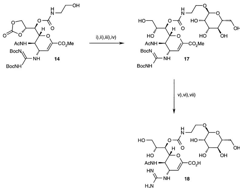
**Figure 8.** Synthetic method D. i) acetobromomannose, AgOTf, DCM  $-30^{\circ}\text{C}$ ; ii) 2,4,6-collidine; iii) NaOMe, MeOH; iv) Dowex 50W X 8; v) NaOH, MeOH,  $\text{H}_2\text{O}$ ; vi) 95% TFA;  $\text{H}_2\text{O}$ .
