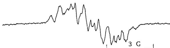
FIG. 6. Spectre de RPE enregistré en cours d'électrolyse sur cathode de  $\text{Cu}/\text{Hg}$  ( $A \approx 2,5 \text{ cm}^2$ ) de la (diméthyl-3',5' hydroxy-4' benzoyl)-2 chromone 5 ( $c = 5 \times 10^{-3}$  M) en présence d'un équivalent de base ( $\text{Me}_4\text{NOH}$ ). Electrolyte support  $\text{Bu}_4\text{NBF}_4$  0,1 M. Champ 3270 G. Gain  $1,6 \times 10^5$  et modulation  $1,6 \times 10^{-1}$  G.  $i = 40 \mu\text{A}$ .
