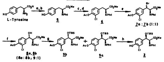
a) N-Ethoxycarbonylphthalimide (1.1 eq); NaOH (2.0 eq), 0°C, 0.5 h, 72%; b) MeOH,  $H_2SO_4$ , reflux, 6 hr, 83%; c)  $SO_2Cl_2$  (1.05 eq), ether, RT, 15 min, 94%; d)  $Ac_2O$  (1.1 eq), Py (1.5 eq),  $CH_2Cl_2$ , RT, 3 h, 96%; e) NBS (1.05 eq), AIBN,  $CCl_4$ , reflux, 6 h, 98%; f)  $AgNO_3$  (1.5 eq),  $CH_3COCH_3-H_2O$ , RT, 3 h, 76%; g) TBDMS-OTf (1.0 eq), 2,4,6-collidine (1.1 eq),  $CH_2Cl_2$ , 0°C, 10 min, 91%; h) NaOMe (1.0 eq), MeOH, RT, 5 min. 71%.
