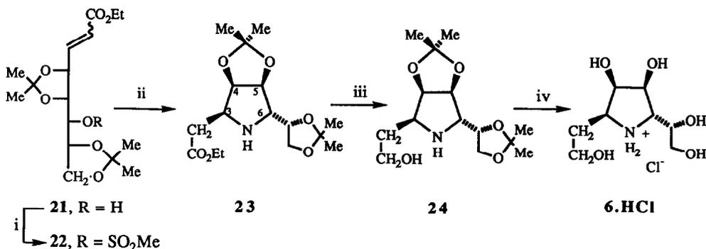
**Scheme 4.** i,  $\text{MsCl}$ ,  $\text{C}_5\text{H}_5\text{N}$ ; ii,  $\text{NH}_3$ ,  $\text{EtOH}$ ; iii,  $\text{LiAlH}_4$ ; iv,  $\text{TFA}\cdot\text{H}_2\text{O}$ , then  $\text{HCl}$ ,  $\text{EtOH}$
