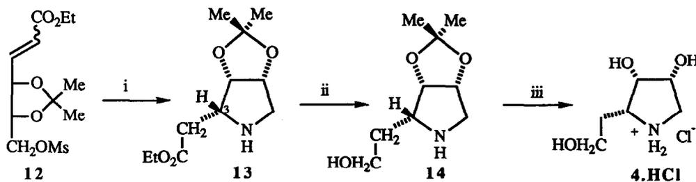
Scheme 2. i,  $\text{NH}_3$ ,  $\text{EtOH}$ , 4 days; ii,  $\text{LiAlH}_4$ ; iii, TFA- $\text{H}_2\text{O}$ , then  $\text{HCl}$ ,  $\text{EtOH}$ ,  $\text{Et}_2\text{O}$
