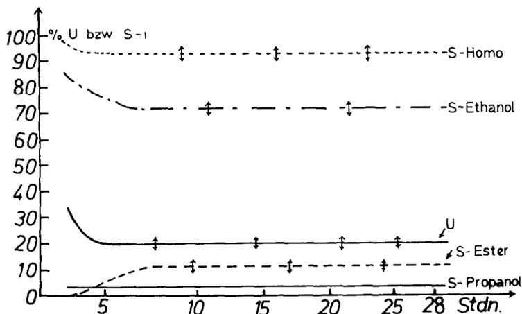
Fig. 1. Zeit-Umsatz  $U$  bzw. Selektivitätskurven  $S-i$  als Funktion der Reaktionszeit bei der Gasphasen-Homologisierung von Methanol mit SLPC  $\text{RuCl}_2(\text{CO})_2(\text{PPh}_3)_2$ ;  $\downarrow$  Schwankungsbreite der einzelnen Analysen. Versuchsbedingungen: Tab. 1 Spalte 2.
