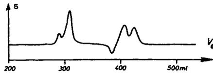
Abb. 3. Gelchromatogramm von Hexahydrophthalsäurediglycidylester nach der alkalischen Verseifung und anschließendem Neutralisieren, getrennt an Sephadex G 10 mit einer wäßrigen Pufferlösung (s. exp. Teil); Höhe des Gelbettes 175 cm.
