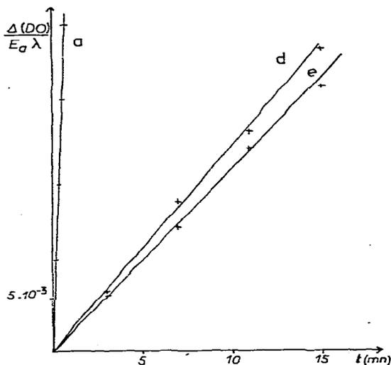
Fig. 2. Courbes de variation de densité optique en fonction du temps  $\Delta(DO)/E_a\lambda = f(t)$ , pour l'obtention du produit monooxydé (a:  $\lambda$  658 nm; b:  $\lambda$  611 nm; c:  $\lambda$  568 nm) et pour l'obtention du produit dioxydé (d:  $\lambda$  620 nm; e:  $\lambda$  578 nm)
