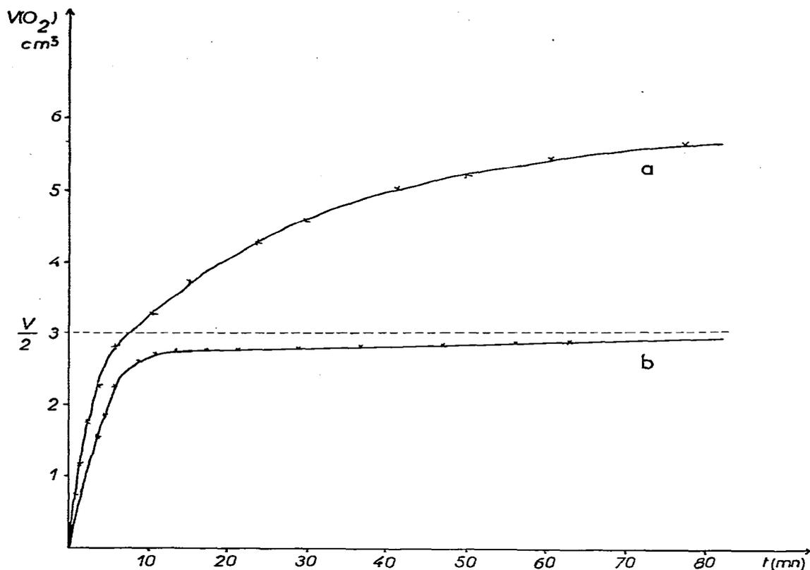
Fig. 3. Absorption d'oxygène en fonction du temps par TPPGeEt<sub>2</sub>: a: sans filtre; b: avec filtre  $\lambda < 620$  nm. T 10°C; c  $1.92 \times 10^{-3}$  ml<sup>-1</sup> (C<sub>6</sub>H<sub>6</sub>); lampe à incandescence: 500 W.
