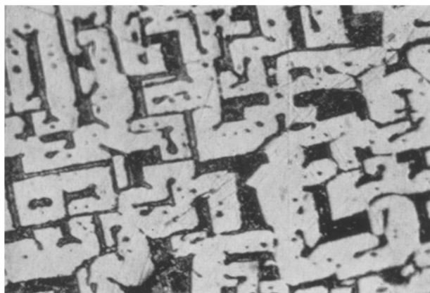
Abb. 5. Gefüge von \text{Ta(4)Si} . \times 600
