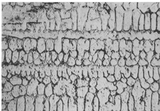
Abb. 7. Gefüge eines Tantal-MK mit 6,1 At.-% Si. \times 600
