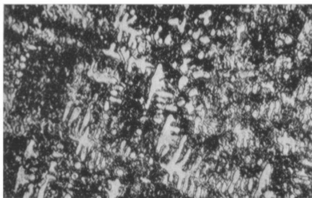
Abb. 6. Gefüge von \text{Ta(5)Si} . \times 600
