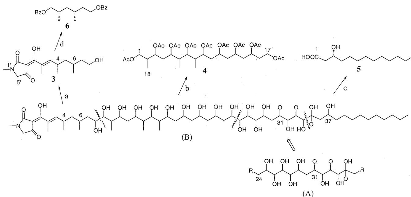
(a)  $\text{NaIO}_4$ ;  $\text{NaBH}_4$ , (b)  $\text{NaIO}_4$ ;  $\text{NaBH}_4$ ;  $\text{Ac}_2\text{O}$ , pyridine, (c)  $\text{NaIO}_4$ , (d)  $\text{O}_3$ ;  $\text{NaBH}_4$ ,  $\text{BzCl}$ , pyridine.
