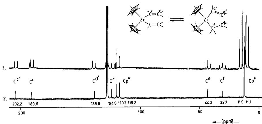
Fig. 2. 50.3-MHz- $^{13}\text{C}$ -NMR-Spektrum des aus  $\text{Cp}_2^*\text{ZrCl}_2$  und  $\text{H}_2\text{C}=\text{CHLi}$  erhaltenen Gemisches aus  $\text{Cp}_2^*\text{Zr}(\text{CH}=\text{CH}_2)_2$  und  $\text{Cp}_2^*\text{ZrCHCHCH}_2\text{CH}_2$  in  $\text{C}_6\text{D}_6$ , ( $T$ :  $25^\circ\text{C}$ ). 1. Gated-decoupling- $^{13}\text{C}$ -NMR-Spektrum; 2.  $^1\text{H}$ -Breitband-entkoppeltes  $^{13}\text{C}$ -NMR-Spektrum.
