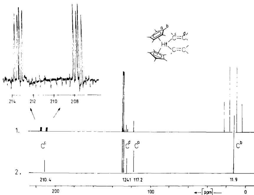
Fig. 3. 50.3-MHz- $^{13}\text{C}$ -NMR-Spektrum von  $\text{Cp}_2^*\text{Hf}(\text{CH}=\text{CH}_2)_2$  in  $\text{C}_6\text{D}_6$ , ( $T$ :  $25^\circ\text{C}$ ). 1. Gated-decoupling- $^{13}\text{C}$ -NMR-Spektrum; 2.  $^1\text{H}$ -Breitband-entkoppeltes  $^{13}\text{C}$ -NMR-Spektrum.
