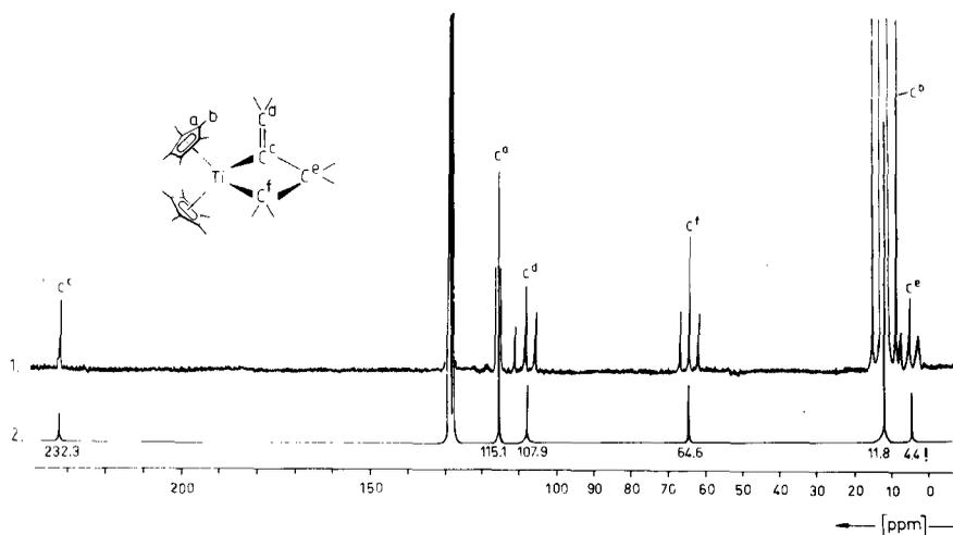
Fig. 1. 50.3-MHz- $^{13}\text{C}$ -NMR-Spektrum von  $\text{Cp}_2^*\text{Ti}(\overline{\text{CH}_2\text{CH}_2\text{CH}_2})$  in  $\text{C}_6\text{D}_6$ , ( $T$ :  $25^\circ\text{C}$ ). 1. Gated-decoupling- $^{13}\text{C}$ -NMR-Spektrum; 2.  $^1\text{H}$ -Breitband-entkoppeltes  $^{13}\text{C}$ -NMR-Spektrum.
