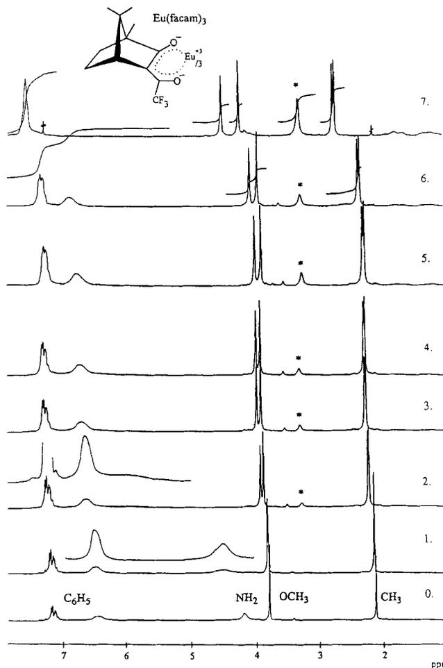
Abb. 1 <sup>1</sup>H-NMR-Spektren (CDCl<sub>3</sub>) von **3a** (0.) sowie in Abhängigkeit vom Konzentrationsverhältnis zwischen dem Shift-Reagenz Eu(facam)<sub>3</sub> (SR)\* und dem Substrat (S) (1.-7.), wobei [SR]/[S]: 1. (0,01), 2. (0,11), 3. (0,21), 4. (0,28), 5. (0,36), 6. (0,43) und 7. (1,00).
