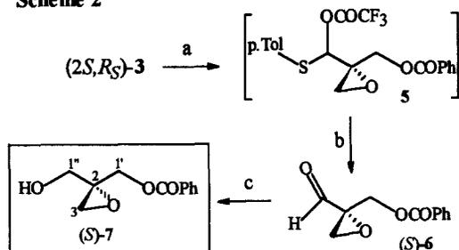
**Reagents and conditions:** a)  $(\text{CF}_3\text{CO})_2\text{O}$ , *sym*-collidine,  $\text{CH}_3\text{CN}$ ; b)  $\text{K}_2\text{CO}_3$ ,  $\text{HgCl}_2$ , 12h; or: r.t., 48h; c)  $\text{H}_2\text{O}$ ,  $\text{NaBH}_4$ .
