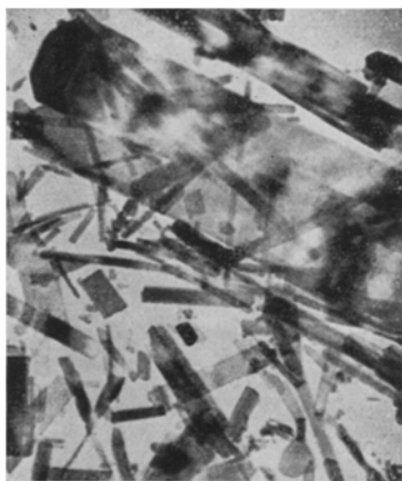
Abb. 3. Hydroxylapatit, umkristallisiert elektronenoptisch 1:18 000, vergrößert auf 1:48 000.
