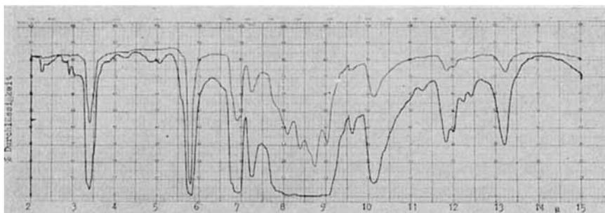
Abb. 3. IR-Spektrum des geradkettigen Tetrameren (III/ $n = 4$ ); mit versch. Schichtd. (kapillare Schicht)
