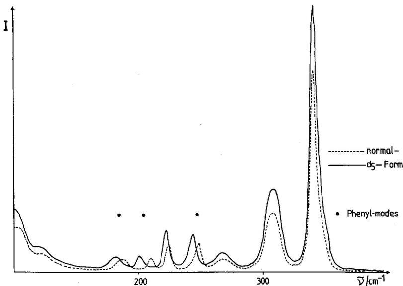
Fig. 3. Ramanspektren von 2-Phenyl- (-----) und 2- $d_5$ -Phenyl- (—) 1,3-dithiastibolan im Bereich 100–390  $\text{cm}^{-1}$  (nicht lagekonstante Sb-Ph-modes u, t und x sind mit • gekennzeichnet).
