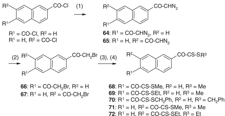
**Scheme 9** (1):  $\text{CH}_2\text{N}_2$ ; (2):  $\text{HBr}$ ; (3):  $\text{S}_8$ ,  $\text{NEt}_3$ ,  $\text{DMF}$ ; (4):  $\text{R}_3\text{I}$ .
