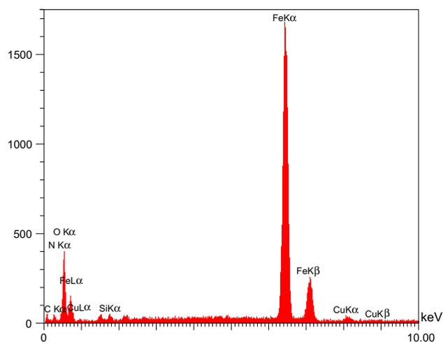
**Fig. 4** EDS spectrum of the  $\text{Fe}_3\text{O}_4$ -DETA-Cu(II)
