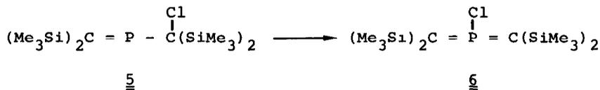
5 ist bei Raumtemperatur stabil, lagert sich aber beim Erhitzen auf 140° C unter 1.2(C → P)-Chlorverschiebung und oxidativer Valenzaufweitung in das P-Chlor-bis(methylen)phosphoran 6 um. Die Umlagerung verläuft vollständig, wenn 5 eine Stunde in o-Xylol unter Rückfluß erhitzt wird oder über eine 10 cm lange Vigreux-Kolonnen destilliert wird; Kp.: 106° C / 0.001 Torr, Fp. 58° C.
