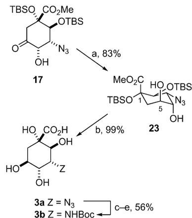
Scheme 9. Reagents and conditions: (a) NaBH<sub>4</sub>, MeOH, r.t.; (b) (i) TFA (aq., 50%), 70 °C, (ii) LiOH, r.t., (iii) Amberlite IR-120 (H<sup>+</sup>), r.t.; (c) Ac<sub>2</sub>O, Py, 0 °C → r.t.; (d) H<sub>2</sub>, PtO<sub>2</sub> (cat.), Boc<sub>2</sub>O, THF, r.t.; (e) (i) LiOH, r.t., (ii) Amberlite IR-120 (H<sup>+</sup>), r.t.
