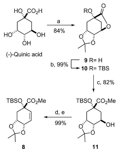
Scheme 2. Reagents and conditions: (a)  $\text{Me}_2\text{C}(\text{OMe})_2$ ,  $\text{HC}(\text{OMe})_3$ , acetone, *p*-TsOH (cat.),  $\Delta$ ; (b) TBSOTf, Py, DCM,  $0^\circ\text{C} \rightarrow \text{r.t.}$ ; (c) KCN, MeOH, r.t.; (d)  $\text{Trf}_2\text{O}$ , Py, DCM,  $0^\circ\text{C}$ ; (e) DBU,  $\text{CHCl}_3$ ,  $\Delta$ .
