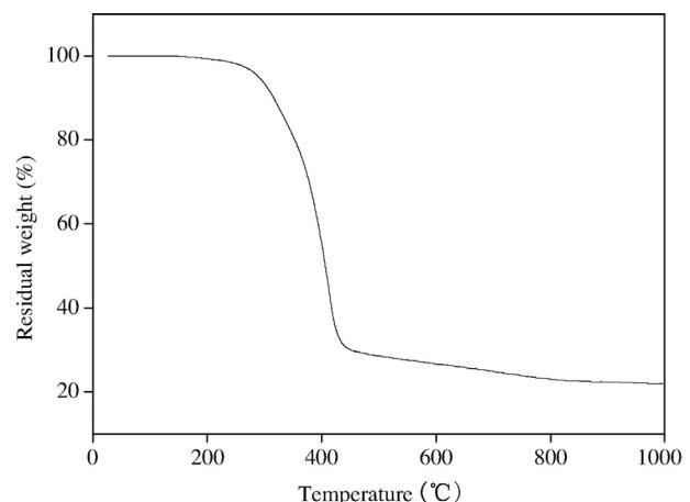
**Fig. 5.** TG curve of  $\text{Fe}_3\text{O}_4/\text{P}(\text{GMA-AA-MMA})-\text{Pd}$ .
