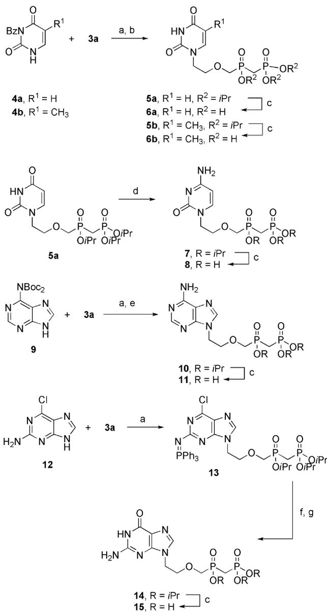
Scheme 2. Mitsunobu reaction of heterocyclic bases with alcohol **3a**. Reagents and conditions: a)  $Ph_3P$ , DIAD, THF, b) MeONa, MeOH, c)  $BrSiMe_3$ ,  $CH_3CN$ , d) 1. TPSCl,  $CH_3CN$ , 2.  $NH_4OH$ , e) HCl,  $CH_2Cl_2$ , f)  $H_2O$ , THF, g) TFAA,  $H_2O$ .
