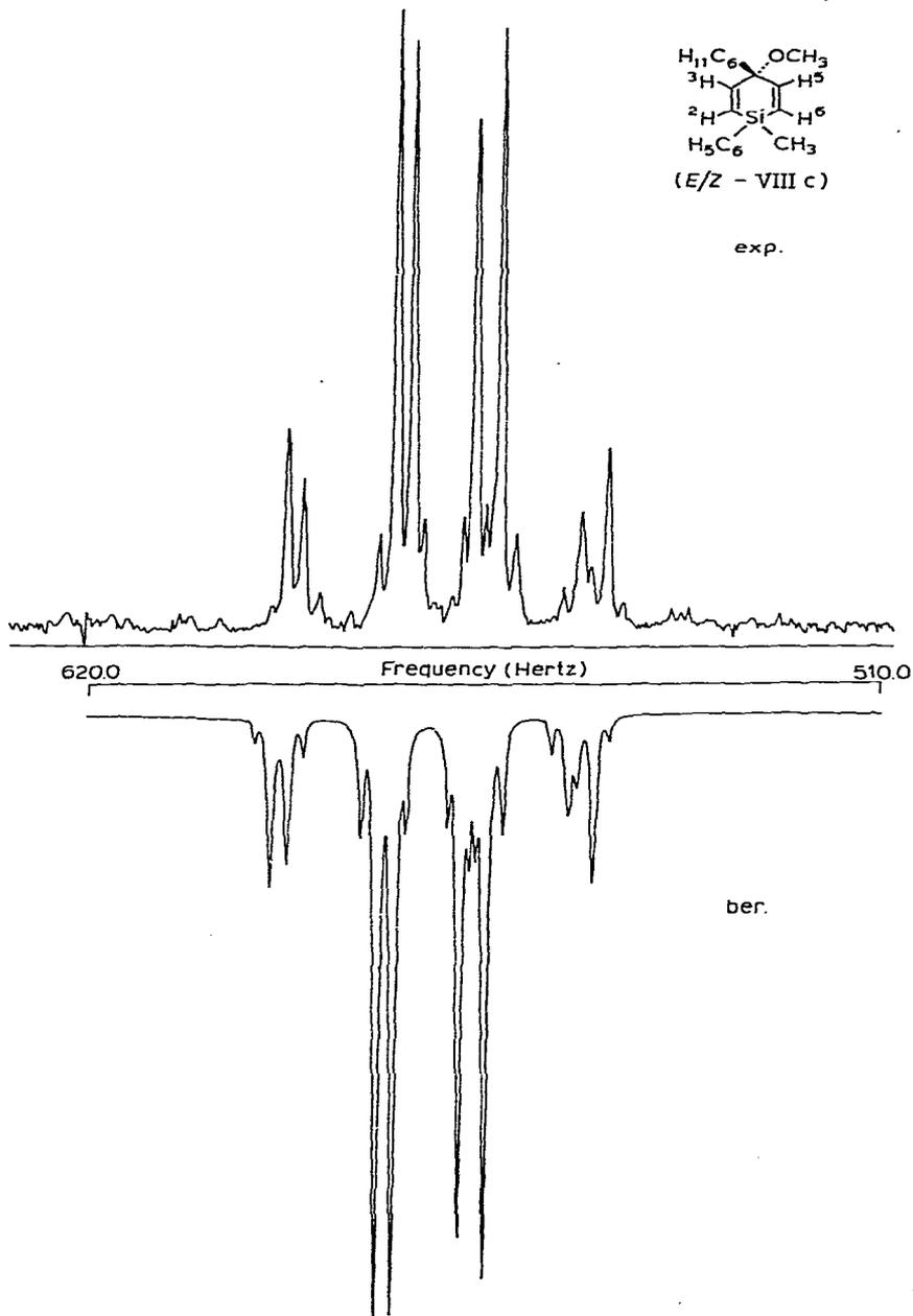
Fig. 2. AA'BB'-Teil des Spektrums von VIIIc. Experimentell und berechnet spiegelbildlich geplottet.
