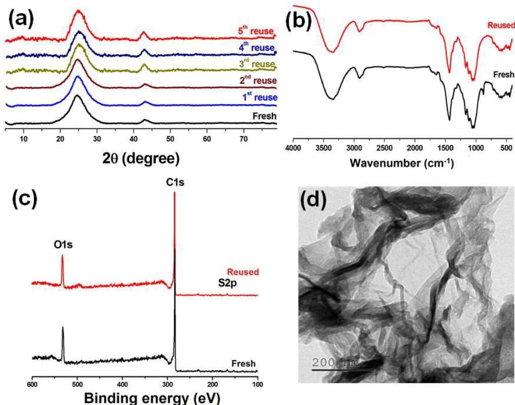
**Fig. 5** (a) PXRD, (b) FT-IR, (c) XPS and (d) HRTEM Image of reused G-SO<sub>3</sub>H
