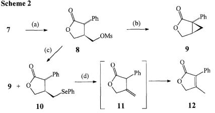
(a): MsCl, Et<sub>3</sub>N, CH<sub>2</sub>Cl<sub>2</sub>, r. t., 1 h, 92%; (b): DBU, CH<sub>2</sub>Cl<sub>2</sub>, r. t., 1 h, 70%; (c): PhSeSePh, NaBH<sub>4</sub>, EtOH/THF, r. t., 3 h, 50% yield of compound 10; (d): 30%  $H_2O_2$ , THF, MgSO<sub>4</sub>, r. t., 24 h, 31%.
