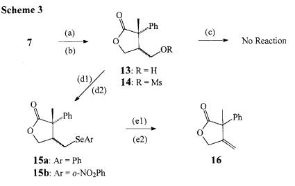
(a): LDA, CH<sub>3</sub>I, THF, -78°C, 6 h, 74%; (b): MsCl, Et<sub>3</sub>N, CH<sub>2</sub>Cl<sub>2</sub>, r. t., 2 h, 97%; (c): DBU, CH<sub>2</sub>Cl<sub>2</sub>, reflux; (d1): PhSeSePh, NaBH<sub>4</sub>, EtOH/THF, r. t., 35 h, 59%; (d2): *o*-NO<sub>2</sub>PhSeSePh-*o*-NO<sub>2</sub>, NaBH<sub>4</sub>, EtOH/THF, r. t., 25 h, 30%; (e1): 30% H<sub>2</sub>O<sub>2</sub>, THF, MgSO<sub>4</sub>, r. t., 24 h, 25%; (e2): 30% H<sub>2</sub>O<sub>2</sub>, THF, r. t., 24 h, 70%.
