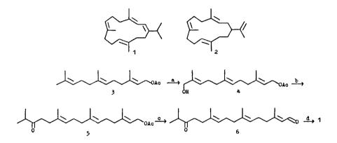
SCHEME: Reagents and conditions: a)  $SeO_2/t$ -BuOOH,  $CH_2Cl_2$ , r. t. (58%); b) 1. Ph<sub>3</sub>P/Imidazole, I<sub>2</sub>,  $CH_3CN$ - $Et_2O(3:2)$ , 0°C ~r. t.; 2. i-PrC(O)Me/LDA, THF, -78°C ~r. t. (54%); c) 1.  $K_2CO_3/MeOH$ , r. t.; 2.  $MnO_2/CH_2Cl_2$ , r. t, (90%); d) TiCl<sub>4</sub>/Zn, Py, DME, reflux (72%)
