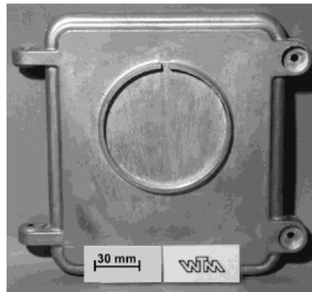
Abb. 2. Plattenförmiges Druckgussteil mit links und rechts je zwei Funktionselementen, das in der vorliegenden Untersuchung als Demonstrationsbauteil diente.
