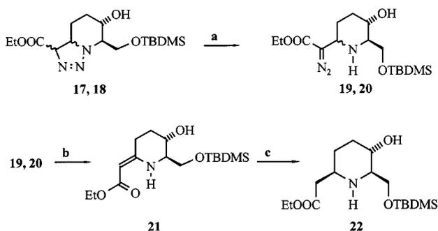
Scheme 6. a) i.  $\text{Et}_3\text{N}$ ,  $\text{CH}_2\text{Cl}_2$ , 12 h, 96%; b)  $\text{Rh}_2(\text{OAc})_4$ , 12 h, 97%; c)  $\text{H}_2$ , 10% Pd/C, EtOH, 48 h, 71%
