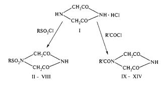
$$\begin{split} & R = C_5H_5 \ (II), \ 4-CH_3C_6H_4 \ (III), \ 4-NO_2C_6H_4 \ (IV), \ 3-NO_2C_6H_4 \ (V), \ 4-CH_3CONHC_6H_4 \ (VI), \ 2-naphthyl \ (VII), \ 2-fluorenyl \ (VIII); \\ & R' = 4-CH_3C_6H_4 \ \ (IX), \ \ 4-CH_3CONHC_6H_4 \ \ (X), \ \ CH_3(CH_2)_6 \ \ (XI), \\ & CH_3(CH_2)_{12} \ (XII), \ CH_3(CH_2)_{14} \ (XIII), \ 9-fluorenyl methyl \ (XIV). \end{split}$$
