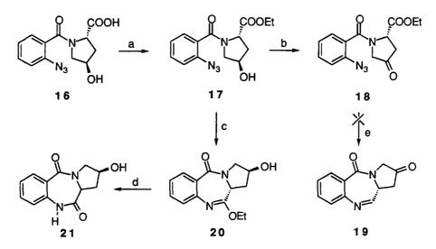
Reagents and conditions: a) EtOH, DCC, 4-DMAP, r.t., b) PCC, CH<sub>2</sub>Cl<sub>2</sub>, r.t., c) PBu<sub>3</sub>, 2 h. r.t., or 1 h. reflux, d) CH<sub>2</sub>Cl<sub>2</sub>, silica gel, e) i) PPh<sub>3</sub>, CH<sub>2</sub>Cl<sub>2</sub>, ii) DIBAL
