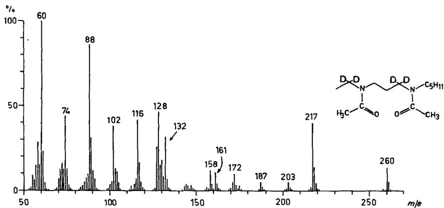
Fig. 3. Massenspektrum von 2,2,6,6-Tetradeuterio-3,7-diacetyl-3,7-diazadodecan (**4c**)<sup>5)</sup>
