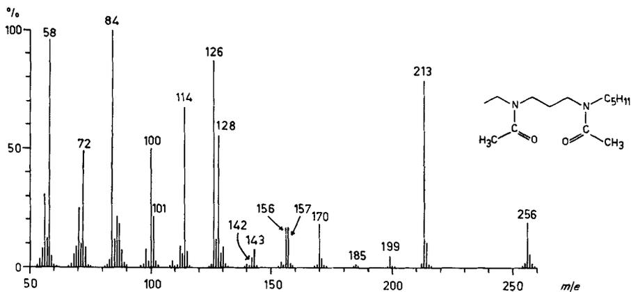
Fig. 1. Massenspektrum von 3,7-Diacetyl-3,7-diazadodecan (**4a**)<sup>5)</sup>
