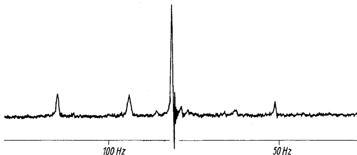
Abb. 1. Charakteristisches PMR-Spektrum des kristallinen Substanzgemisches aus der Pyrolyse des \text{CH}_3\text{SiCl}_3 ; Lösungsmittel \text{CCl}_4 ; 60 MHz
