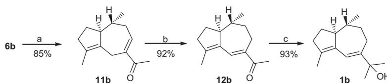
**Scheme 4.** Reagents: (a)  $MsCl$ ,  $Et_3N$ ,  $CH_2Cl_2$ , rt, 6 h; (b)  $RhCl_3 \cdot H_2O$ , EtOH; (c)  $MeMgCl$ , THF.
