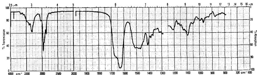
Fig. 1. IR.-Spektrum von Cyclosporin C in  $\text{CH}_2\text{Cl}_2$
